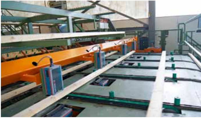
Vier Röntgendetektoren ermitteln die Dichte der Hauptware
