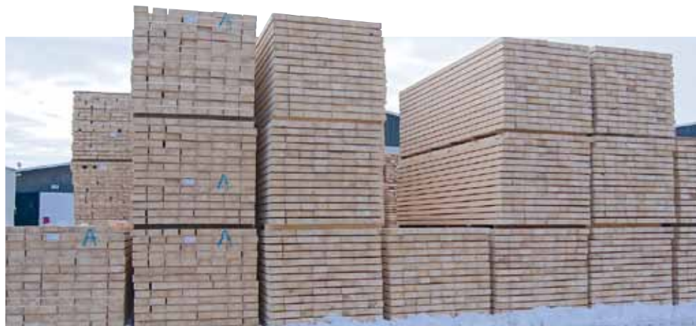
Noch feucht hinter den Stapellatten, aber schon festigkeitssortiert: Rettenmeier sortiert in Hirschberg die KVH-Rohware noch vor der Trocknung – ein Novum in Deutschland
