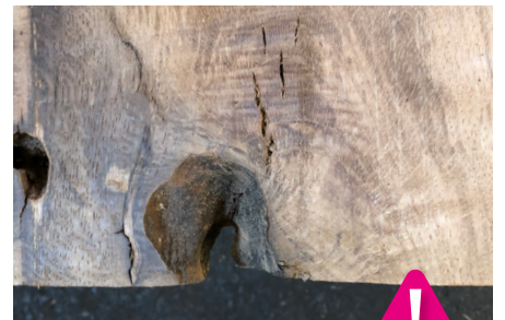
Kantenausbruch - bis 50 mm zulässig
