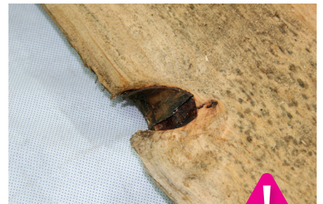
Kantenausbruch - bis 10 mm zulässig
