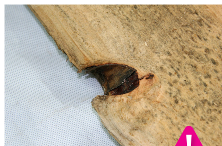
Vylomené hrany – přípustné do 10 mm
