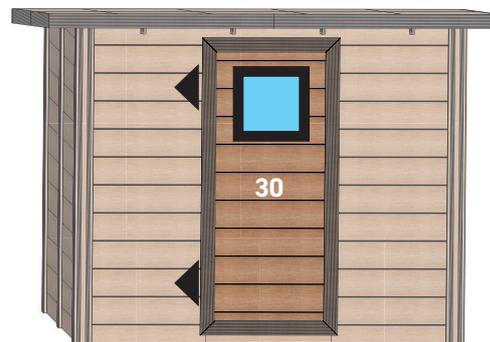
**Tip:** Die sich aus Nut und Feder ergebende Linie der Türelemente verlaufen gleichermaßen der Linien der Wandelemente.
