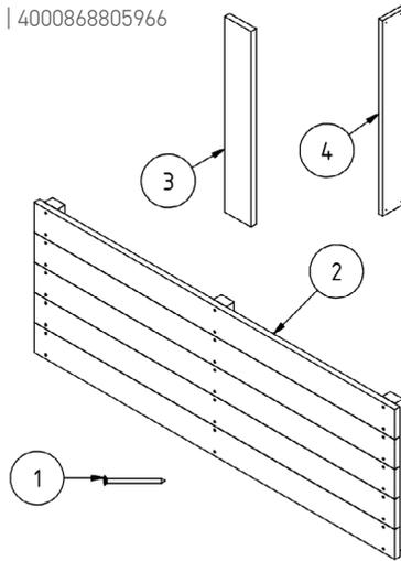
**Tipp:** Vorbohren wird empfohlen! Stellen Sie das Beet auf einige Gehwegplatten. Auf der Unterseite einen engmaschigen Draht zum Schutz gegen Wühlmäuse befestigen. Gegen Vergrauen empfehlen wir eine regelmäßige Behandlung.
