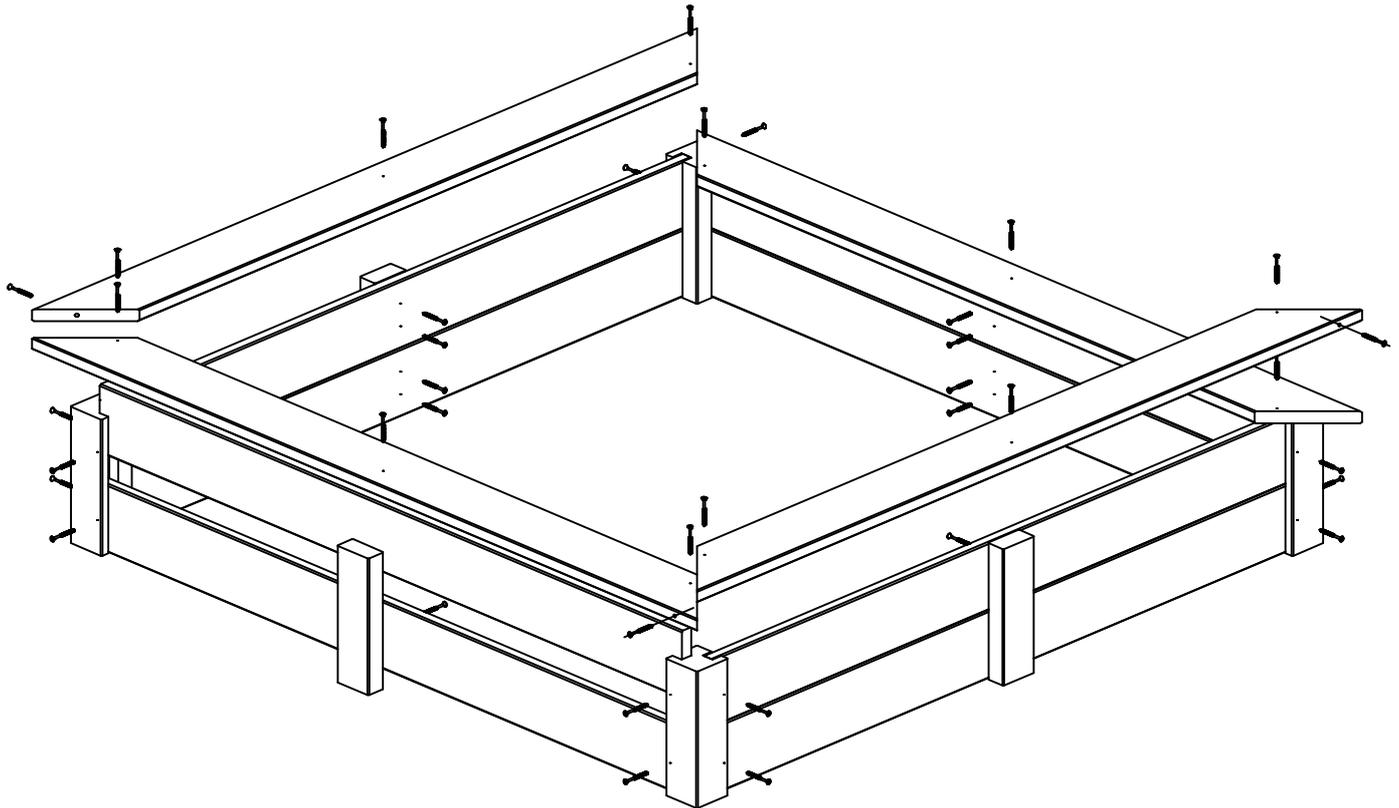
Die Seitenbretter in die Nutungen der Kanthölzer stecken und verschrauben. Danach die vier Sitzbretter auflegen, ausrichten und verschrauben. Zuletzt die Unterstüthungshölzer befestigen.
